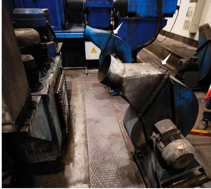
Şekil 37. Sıcaklık sorunu nedeniyle eşanjöre ek olarak fanların kullanılması (MET Didactic)
