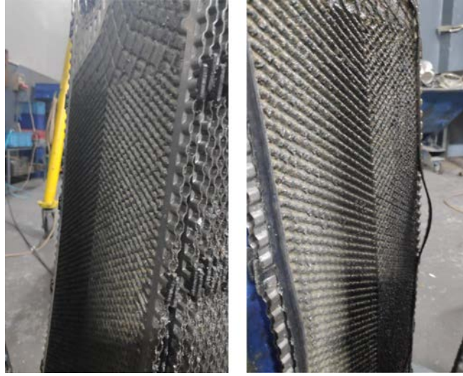
Şekil 31. Bakım için sökülmüş plakalar (MET Didactic)
