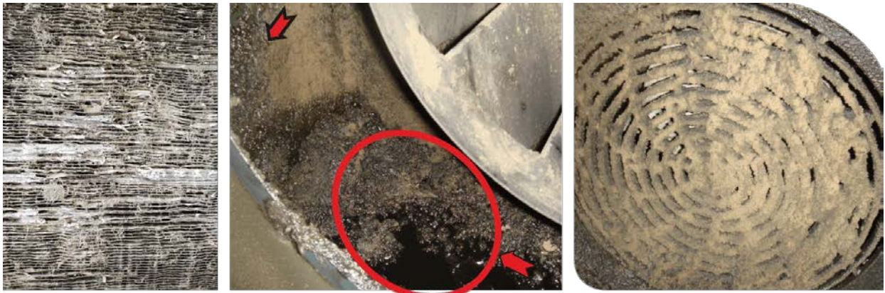
Şekil 12. Soğutucu üzerine yapışan tozlar verimi düşürür (MET Didactic)
