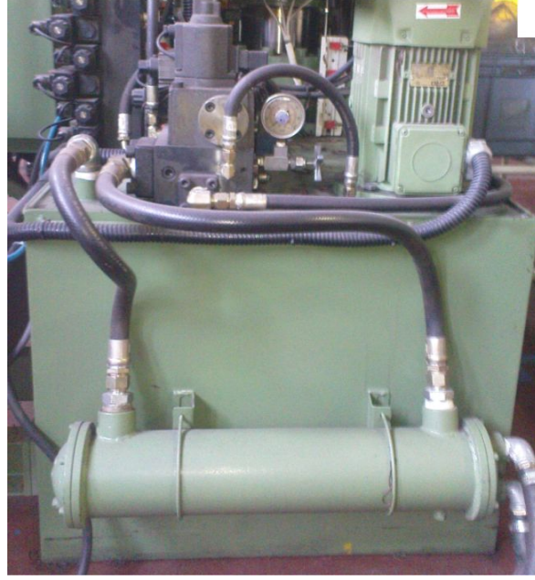
Şekil 19. Boru tip eşanjörün kullanım yeri (MET Didactic)
