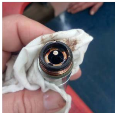
Şekil 3. Yağ sıcaklığının artmasının etkileri (MET Didactic).
