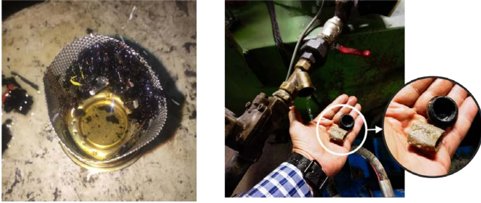
Şekil 25. Su filtresinde meydana gelen kirlenme (MET Didactic)
