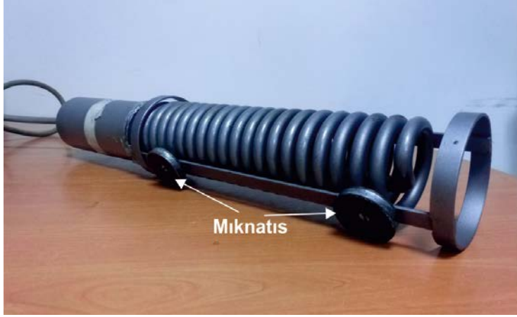
Şekil 33. Daldırma tip ısıtıcı (MET Didactic)
