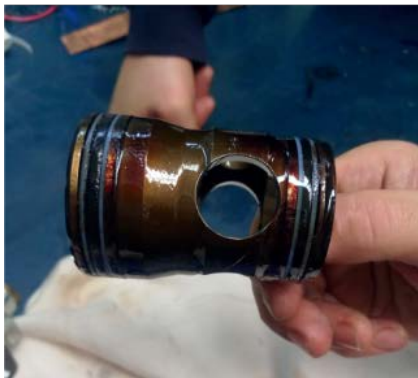
Şekil 3. Yağ sıcaklığının artmasının etkileri (MET Didactic).
