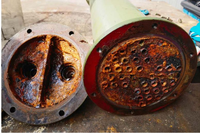
Şekil 24. Boru tip eşanjörün paslanması (MET Didactic)
