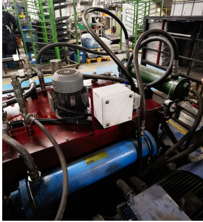
Şekil 23. Birden fazla eşanjörün birbirine seri bağlanması (MET Didactic)
