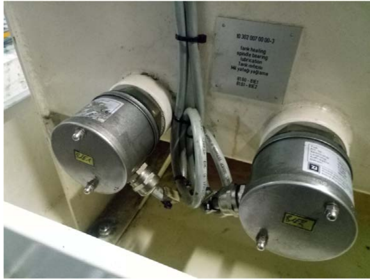
Şekil 34. Gövde üzerine monte edilen ısıtıcı (MET Didactic)
