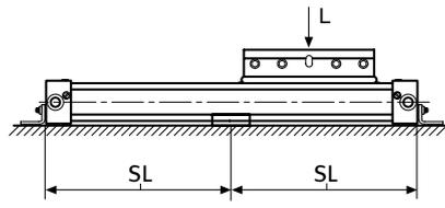
max. Stützlänge (SL) in mm - ohne Mittenstücke Nr. 25
